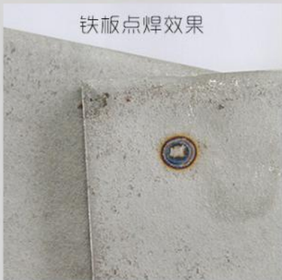
2mm不锈钢板点焊效果
